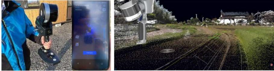
回転するレーザーキャナで歩きながらリアルタイムで現況地形や構造物の形状を計測することができる、ハンディーなレーザーキャナ。機器構成は、レーザーキャナと、レーザーキャナの姿勢を計測するIMUセンサ、内蔵カメラ。
